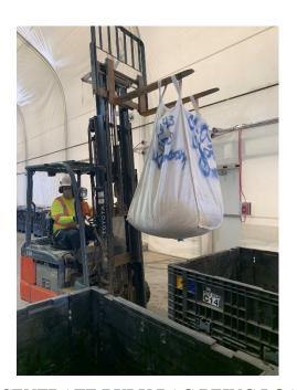
PLATE 4: DMS CONCENTRATE BULK BAG BEING LOADED INTO SEALED PLASTIC CONTAINER
