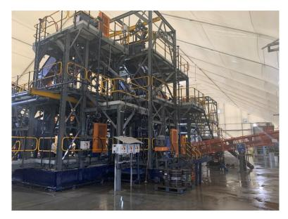
**PLATE 3: RTEC DMS CIRCUIT**
